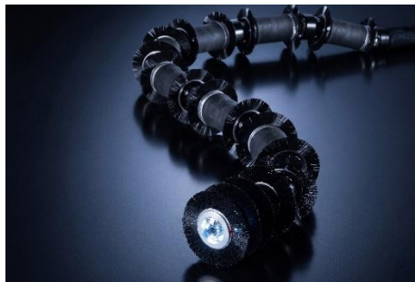
ミズ型管内走行ロボット「Sooha」
